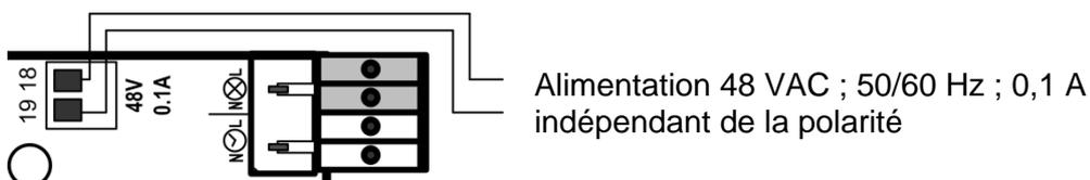
Une borne à ressort grise (18,19) est disponible pour l'alimentation du mouvement 48 VAC. Les fils de connexion doivent être dénudés sur 5 à 6 mm. Section de fil d'au maximum  $2,5 \text{ mm}^2$ . Un dispositif de séparation à 2 pôles doit être prévu dans la conduite d'alimentation par le client.
